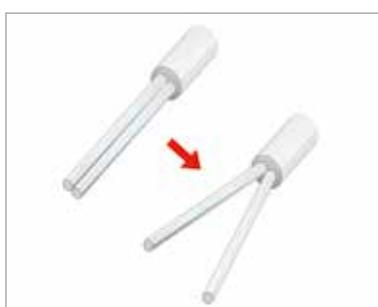
Dividere i due cavetti separando l'isolamento nella parte centrale.
