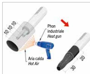
Infilare il cappuccio ESPC sull'estremità e provvedere alla chiusura del termorestringente.
